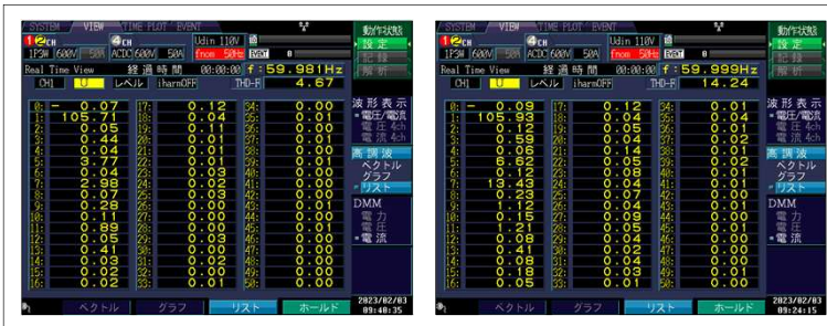
2. 発電前と発電中の電圧比較（50次までの高調波）
